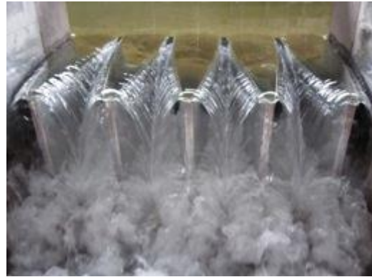
Instalación para experimentación de aliviaderos en laberinto y en tecla de piano
