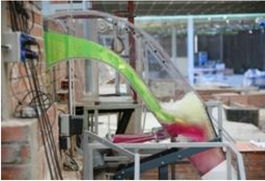
Instalación para experimentación de aliviaderos en sifón
