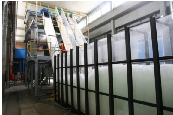
Instalación para experimentación de aireación forzada en aliviaderos y optimización de cuencos
