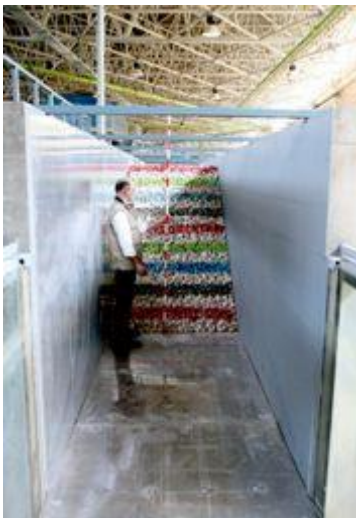
Instalación para experimentación del comportamiento de presas de materiales sueltos ante sobrevertidos por coronación
