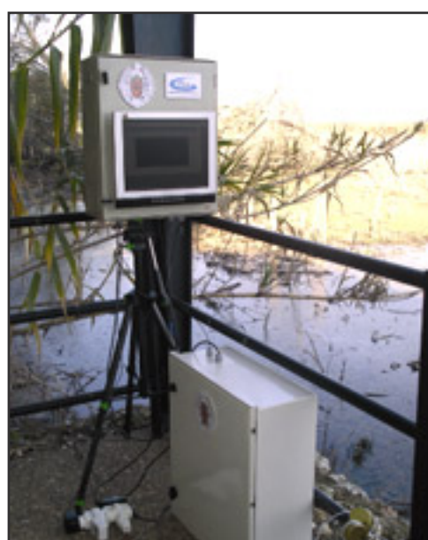
Biosensor luminiscente sobre fibra óptica para la medida de pesticidas, basado en microalgas como elementos de reconocimiento, monitorizando el agua de la marisma del Parque Nacional de Doñana en el observatorio de El Bolín.
