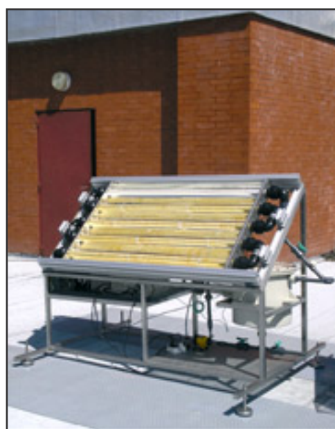
Reactor fotoquímico solar piloto para desinfección del agua de consumo familiar diario para núcleos rurales aislados de países menos favorecidos desarrollado por el Grupo de Sensores Optoquímicos-Laboratorio de Fotoquímica aplicada (GSOLFA) de la UCM
