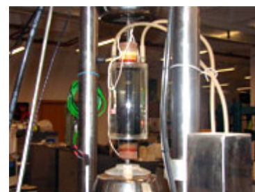
Ensayo de carga constante en ambiente corrosivo
